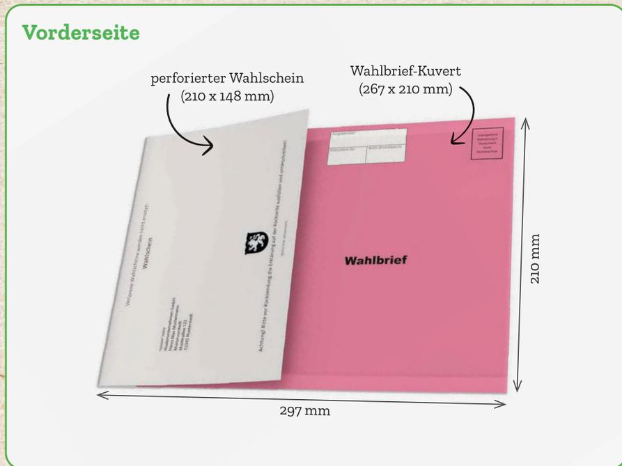
Abbildung 11: Vorderseite des Kombiwahlscheines Größe L
